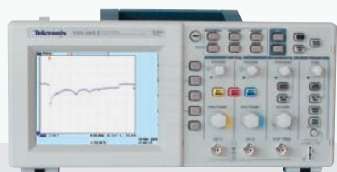
用示波器记录机动车辆真实电压数据
