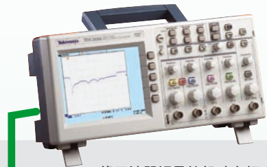
将示波器记录的机动车辆真实电压曲线导入计算机
