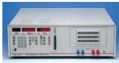
模拟车辆 发动机 启动脉冲
