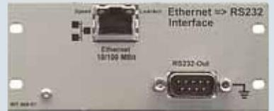
该选件使设备扩展增加LAN接口。数据由LAN卡发送到设备串口。安装使用该选件需先配备ZS01选件。
